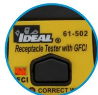
**Déclenche le disjoncteur DDFT** dans le circuit en appuyant sur le bouton noir
