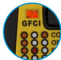
**Lampe-témoin** s'allume, indiquant l'activation du test du disjoncteur DDFT et le DDFT se déclenche s'il fonctionne correctement
