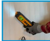
Faites pivoter le récepteur pour trouver la lecture numérique la plus élevée. Cela est nécessaire pour suivre les variations de l'intensité du signal lors du traçage, en raison des courbures, des torsions et des conducteurs qui circulent plus profondément ou moins profondément le long de leur chemin. Des variations de puissance du signal se produisent et peuvent nécessiter un ajustement constant de l'angle du récepteur pour le suivre.
