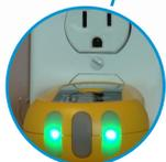
Indication de la polarité et de circuit sous tension
