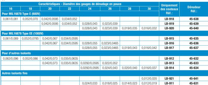
Tolérances: diamètre de la gauge de dénudage : ± 0,001; Diamètre du contre-alésage: ± 0,002.
