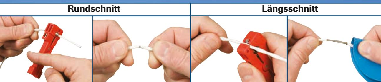
Drehen Sie die Abisolierzange vom Körper weg nach unten. Für gewöhnlich reichen 2 bis 3 Umdrehungen aus, um einen vollständigen Schnitt in die Isolierung einzubringen.
